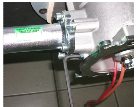
6) Отвинтить 2 винта см. рис.6-7;
