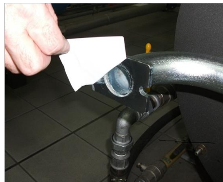
6) Снять заглушку из Труба ГАЗОВОЙ рампы;
