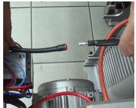
3) Отсоединить кабель электрода ионизации от разъема;
