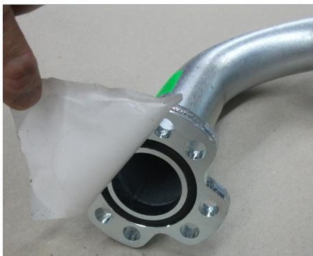
4) Снять заглушку из фланец и удостовериться, что прокладка фланца рампы установлена в правильном положении;
