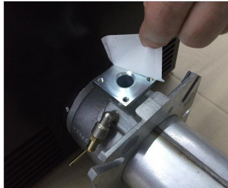
2) повернуть Горелка и Снять заглушку;
