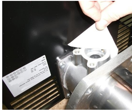
2) повернуть Горелка и Снять заглушку;
