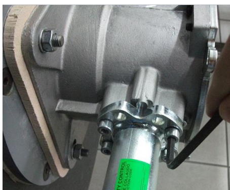
5) Прикрепить Труба ГАЗОВОЙ рампы в фланец при помощи 4-х винтов с цилиндрической головкой;
