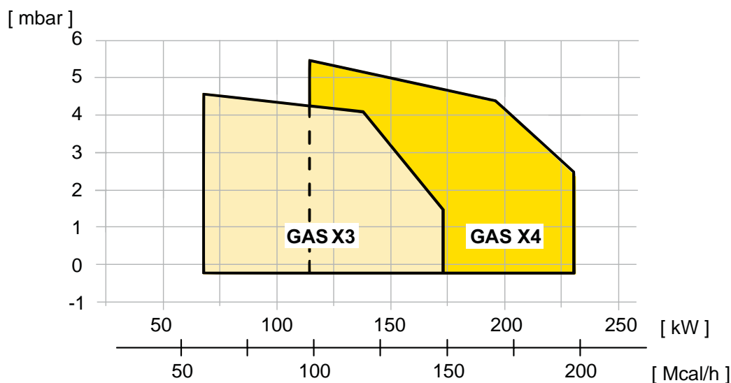
Fig. 2 X = Мощность Y = Сопротивление камеры сгорания
