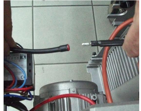
3) Отсоединить кабель электрода ионизации от от разъема;
