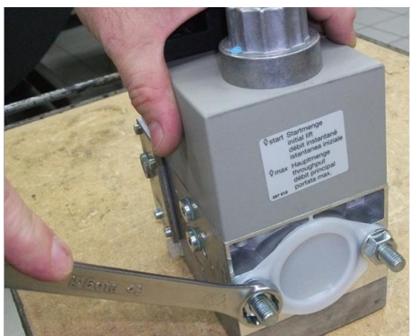
7) Снять заглушку из электроклапан;
