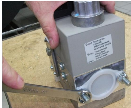
8) Снять заглушку из электроклапан;
