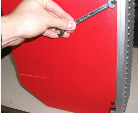
1) Снять кожух, ослабив 4 винта;
