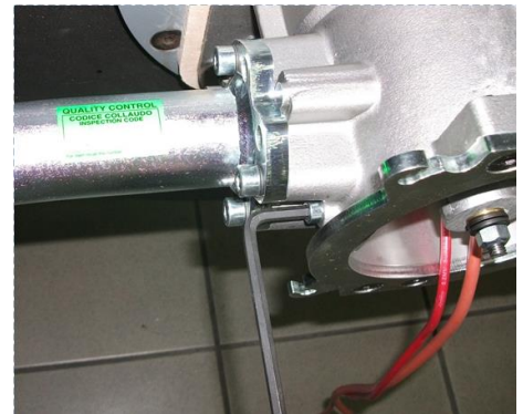
6) Отвинтить 2 винта см. рис.6-7;
