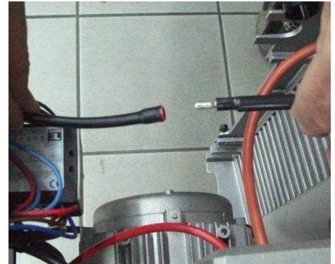
15) Подсоединить кабель электрода ионизации к разъему
